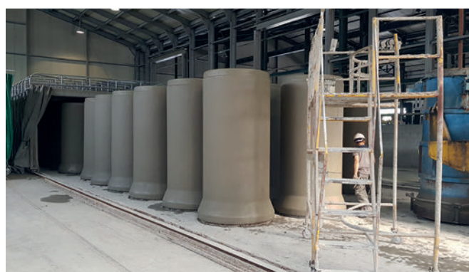
Tuyaux en béton DN 1000 avec joint intégré fraîchement démoulés
