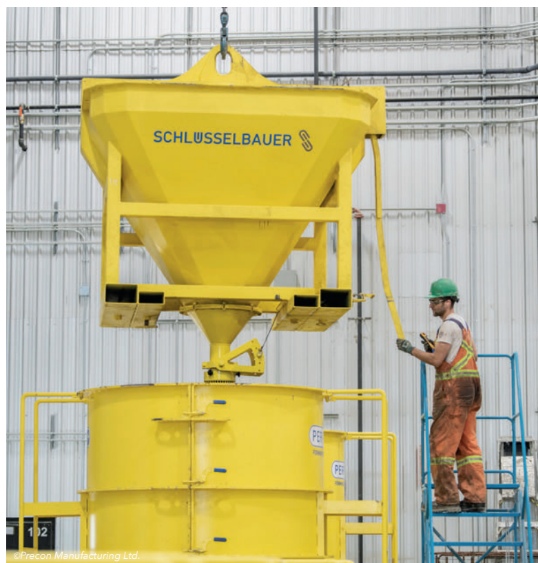
La trémie à béton mobile peut être utilisée au moyen d'un pont roulant ou d'un chariot élévateur.
