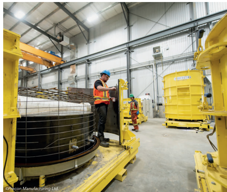
Préparation des cunettes, échelons et armatures dans la paroi et dans le fond.
