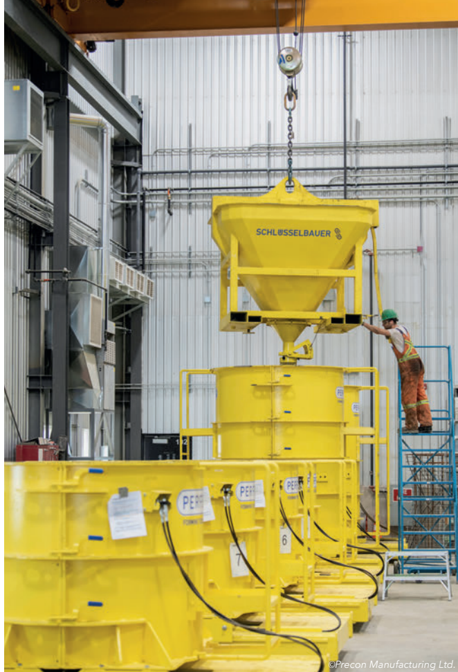
Des moules pour différentes hauteurs sont remplis de béton auto-plaçant.
