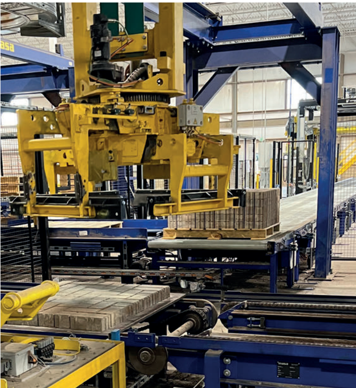
Le robot de paquets électrique de Masa empile les couches de produits avec précision et crée des paquets de blocs sans endommager les produits.
