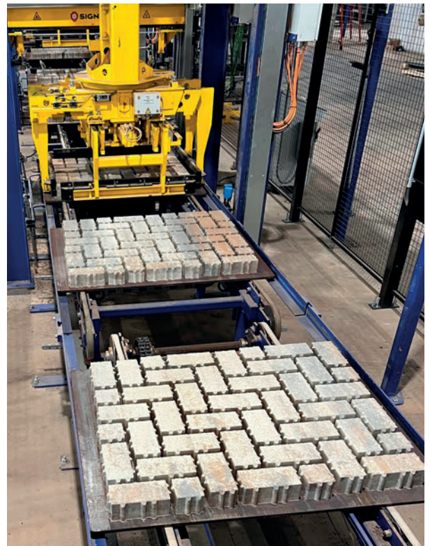
Le robot de paquets électrique de Masa empile les couches de produits avec précision et crée des paquets de blocs sans endommager les produits.
