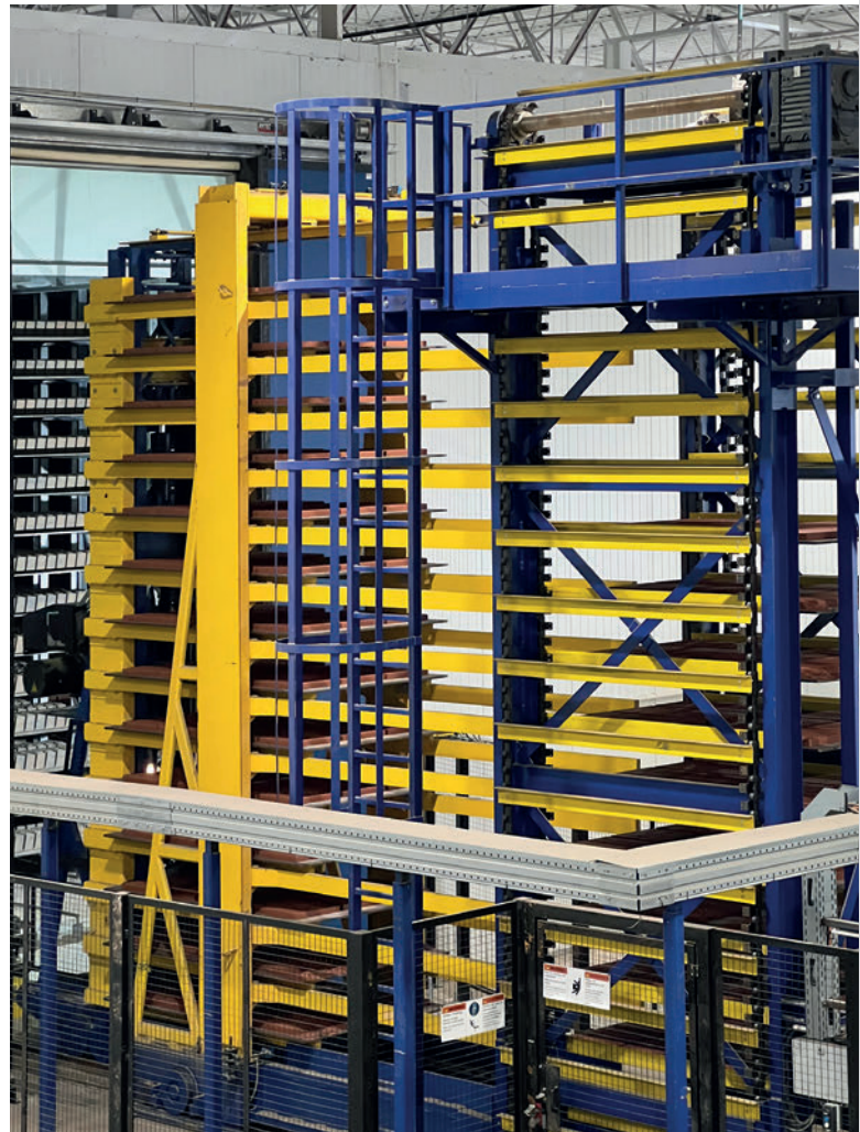
Chariot de transport de Masa avec dispositif rotatif (14 niveaux, bi-couche, à fourches vissées)
