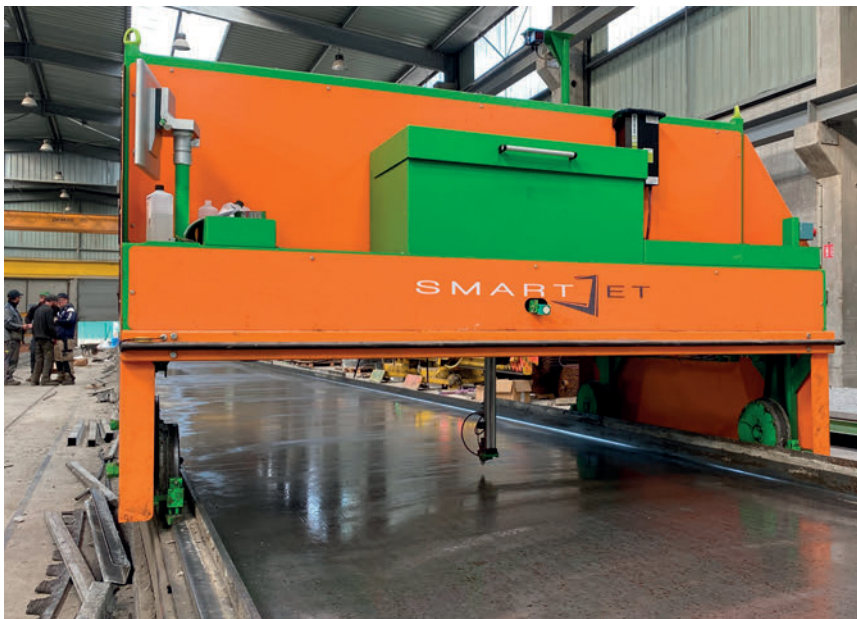
El plóter SmartJet automático permite trazar marcas para insertos, encofrados y huecos.
