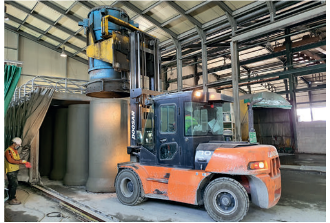
Fabricación profesional de tubos de hormigón DN 1000
