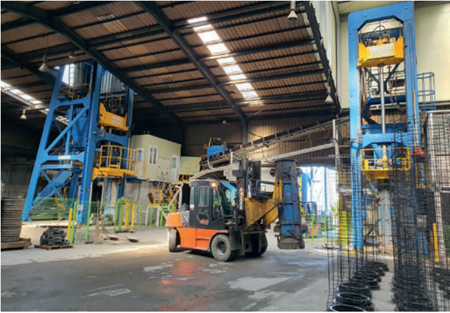
Preparación de la producción de tubos de hormigón
