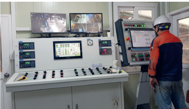
Cabina de control con panel multifunción RP, con el nuevo sistema de visualización para prensas radiales tipo Karajan
