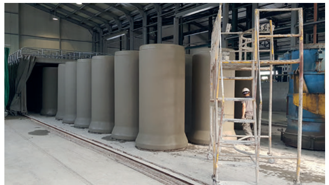
Tubos de hormigón recién desencofrados DN 1000 con junta integrada
