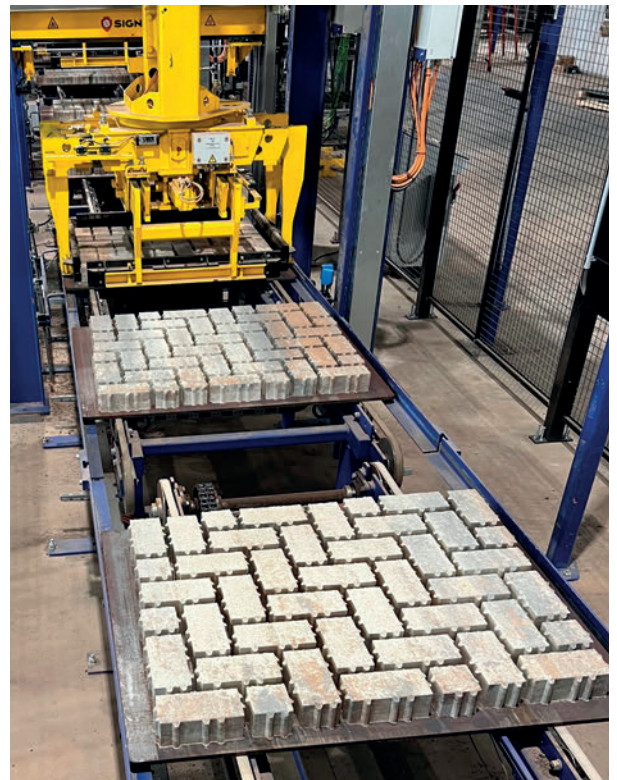
La empaquetadora eléctrica de Masa junta las planchas con precisión y crea paquetes de bloques sin dañar los productos
