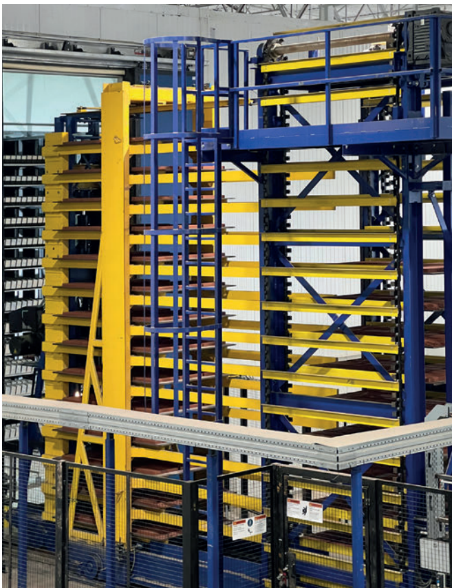
Carro multiforca con dispositivo de giro Masa (14 pisos, dos capas, horquillas atornilladas)
