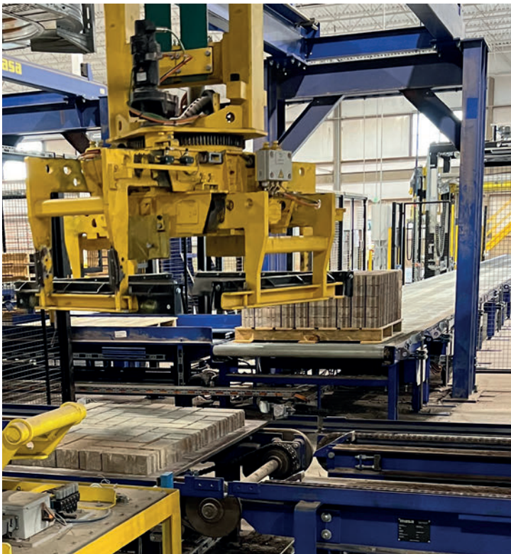
La empaquetadora eléctrica de Masa junta las planchas con precisión y crea paquetes de bloques sin dañar los productos
