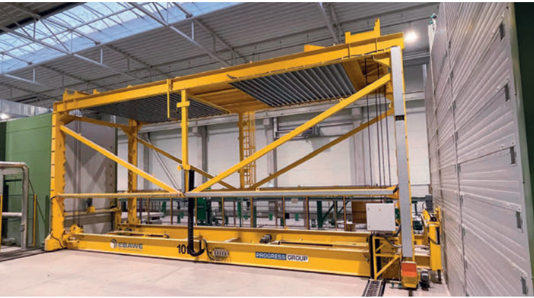
La apiladora de paletas coloca los elementos en la estantería de curado
