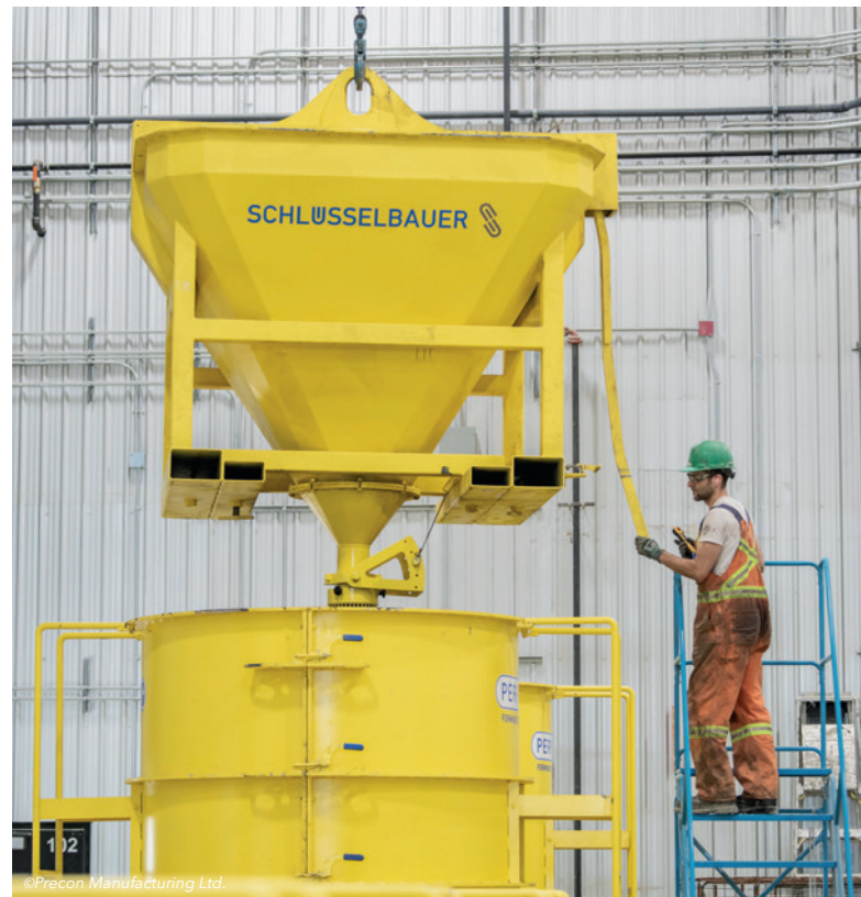
Der mobile Betonsilo kann mittels Hallenkran oder Stapler bedient werden.
