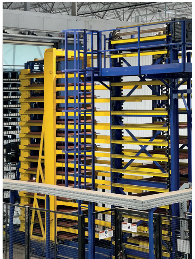
Masa-Gabelwagen mit Drehvorrichtung (14 Etagen, zweischichtig, geschraubte Gabeln)
