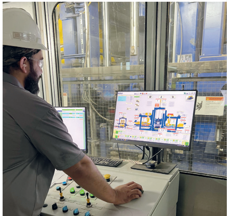
Animierte Echtzeit-Steuerungen ermöglichen es dem Bediener, alle Prozesse jederzeit von mehreren Bildschirmen aus zu sehen.
