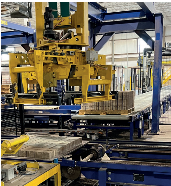
Der elektrobetriebene Paketierer von Masa legt die Lagen präzise aufeinander und erzeugt Steinpakete, ohne die Produkte zu beschädigen.
