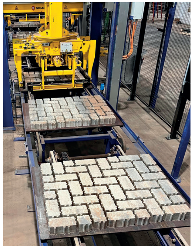
Der elektrobetriebene Paketierer von Masa legt die Lagen präzise aufeinander und erzeugt Steinpakete, ohne die Produkte zu beschädigen.
