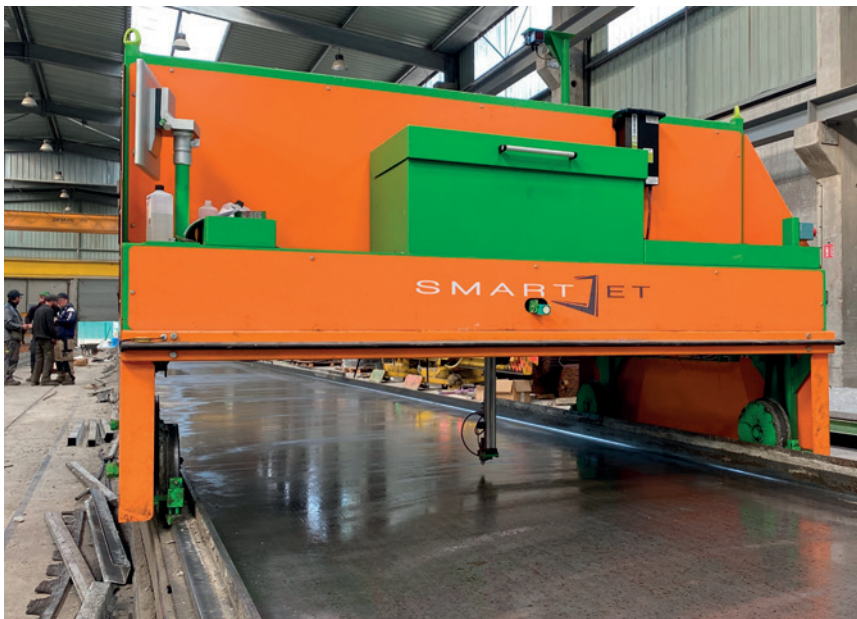
Der automatische SmartJet Plotter ermöglicht die Markierung für Einsätze, Schalungen und Aussparungen.
