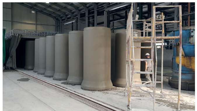
Frisch entschalte Betonrohre DN 1000 mit integrierter Dichtung
