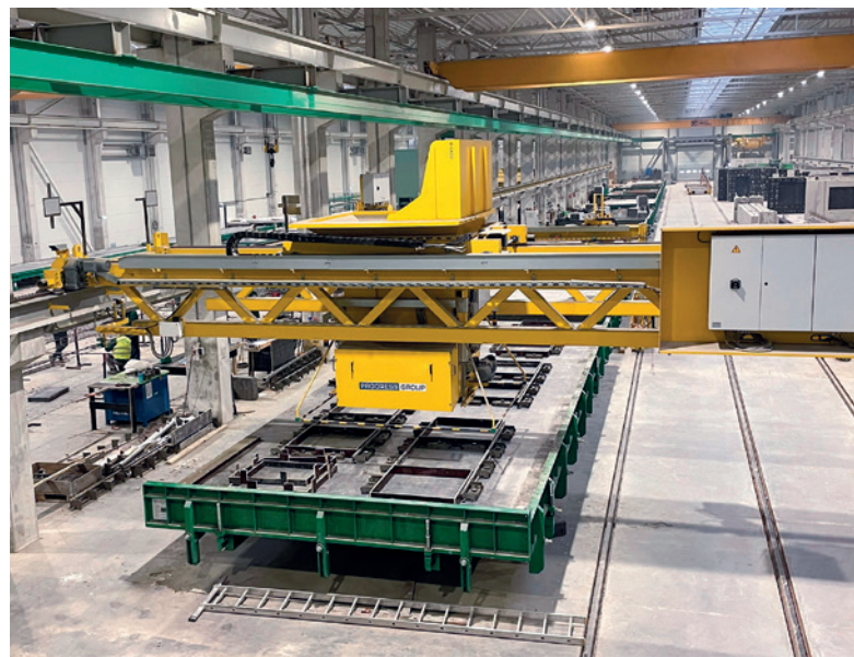
在托盘上飞行的混凝土输送系统完全自动化地处理输送，并具有准确的数据，因此节省了混凝土布料时间
