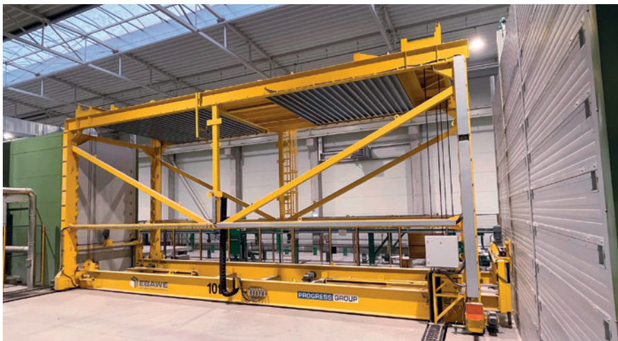
托盘堆垛机正在将筑造构件堆垛到固化架上
