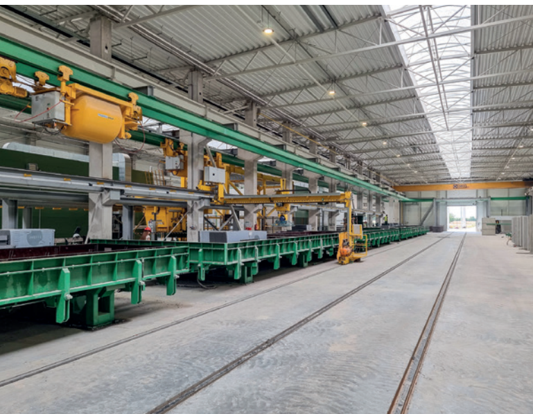
倾斜台用于生产大面积扁平预制混凝土构件，如实心墙或夹层墙
