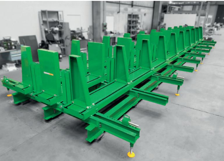
双模具用于生产最畅销的产品——立柱，长 14 米
