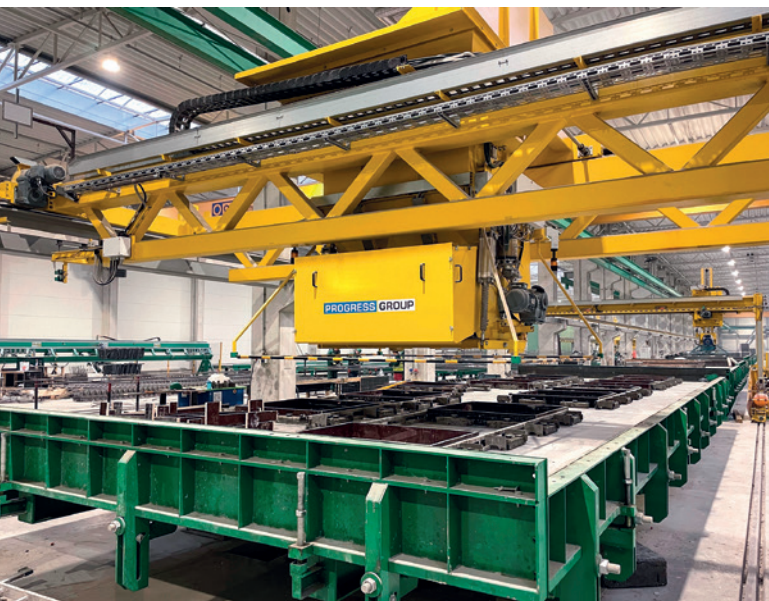
在托盘上飞行的混凝土输送系统完全自动化地处理输送，并具有准确的数据，因此节省了混凝土布料时间
