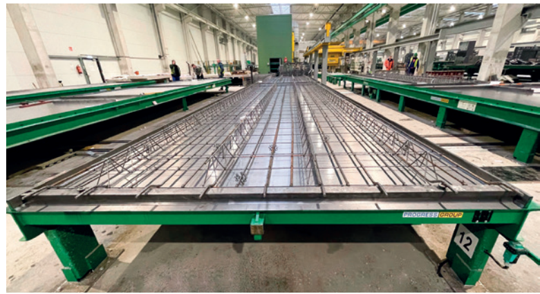
构件中的钢筋正在自动布局，因此完全符合设计
