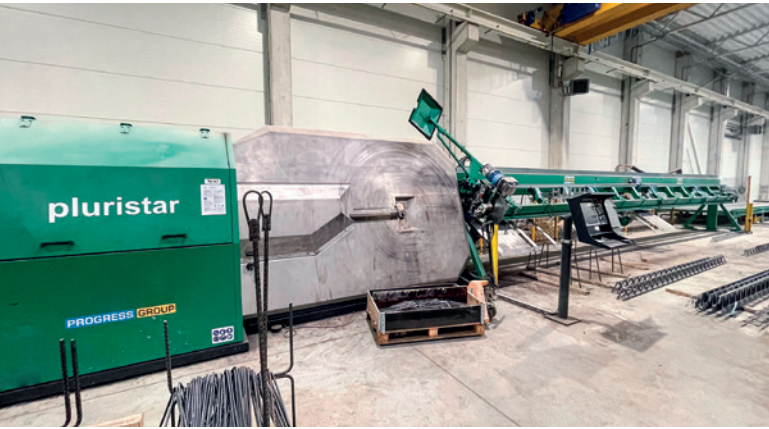
多功能 Pluristar 机械可以直接从卷材上拉直、切割和弯曲所需的钢筋。
