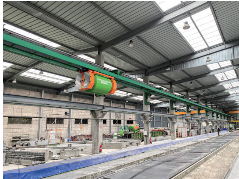
飞斗 D-Flyer 将干或湿混凝土从混凝土搅拌机运输到高架轨道上生产设施的指定位置
