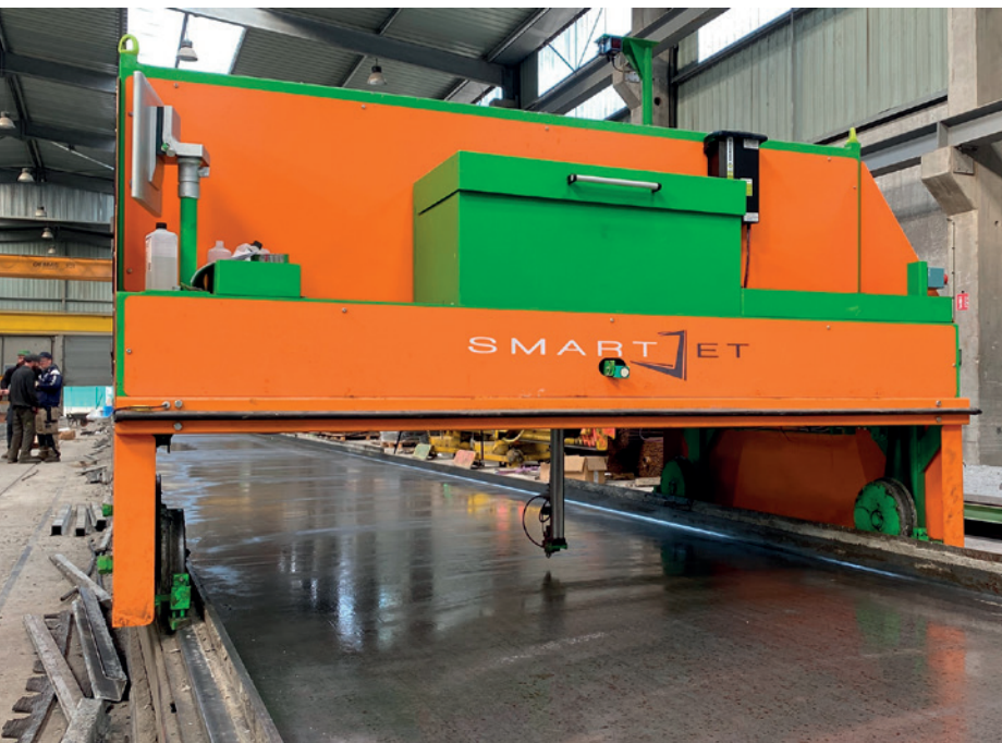
自动绘图仪 SmartJet 使绘制数据成为可能，如百叶窗放置和切割
