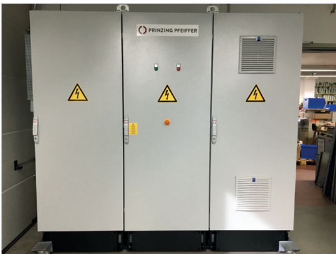
图 11: 径向压力机 RP1230 的电气控制系统，内置在一个 3 门控制柜中，带有最新的全球验证的西门子 Simatic S7 PLC 技术
