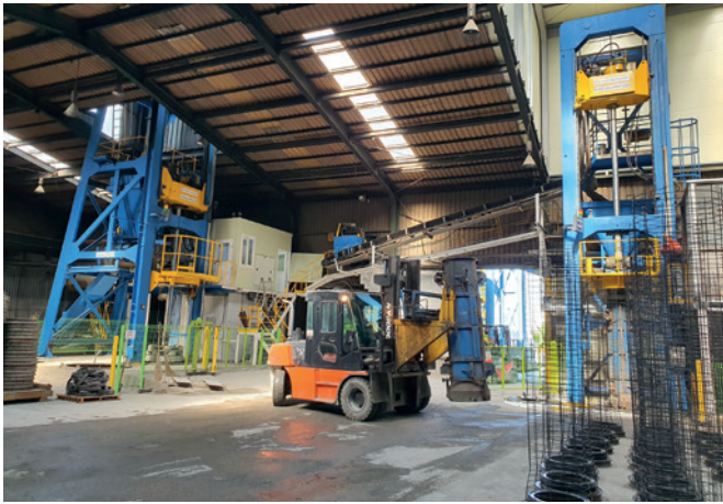
图 7: 混凝土管生产准备
