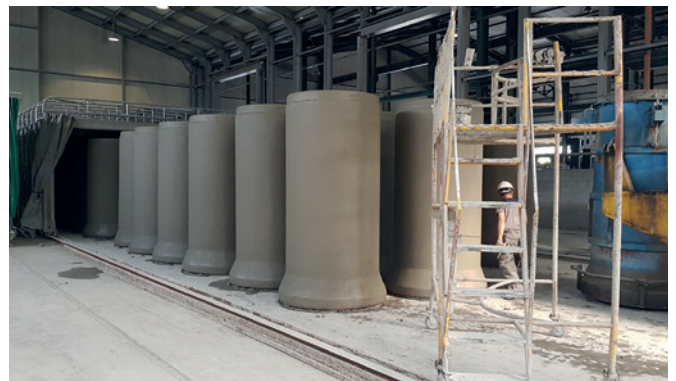
图 10: 新生产的带集成垫圈的混凝土管 DN 1000
