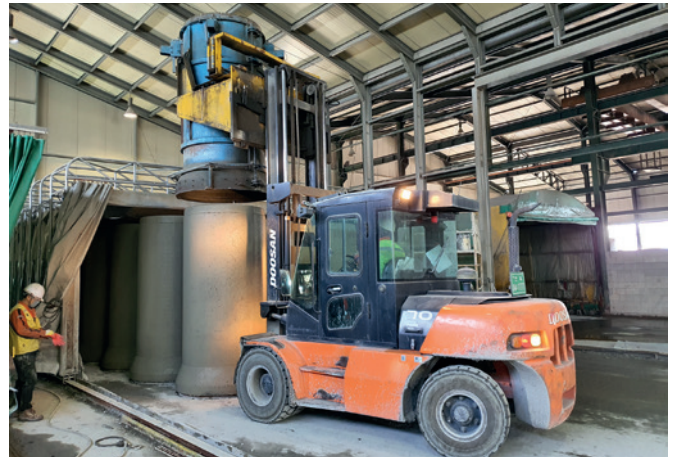
图 8: 混凝土管 DN 1000 的专业生产
