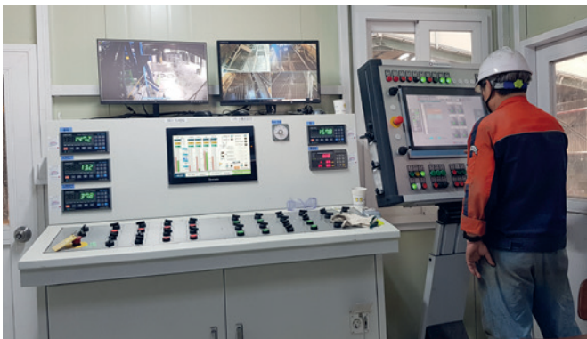
图 9: 径向压力机控制室——带有新的可视化系统类型“Karajan”的多功能面板
