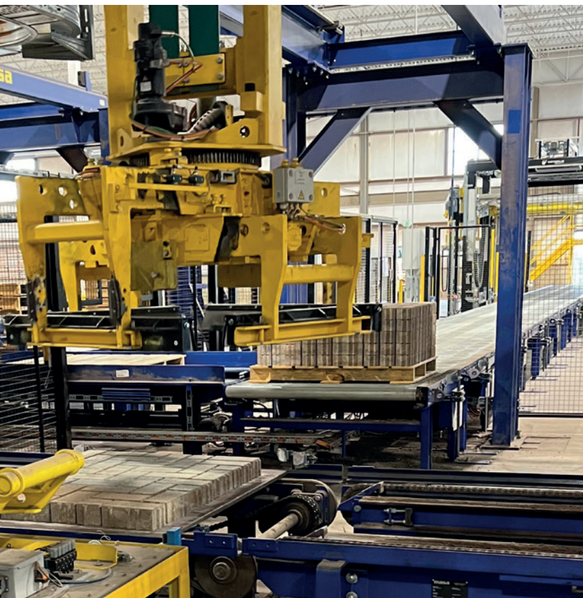
Masa 的电驱动立体升降机精确地将栈板放置在输送系统上，并在不损坏产品的情况下生成精确的立方体
