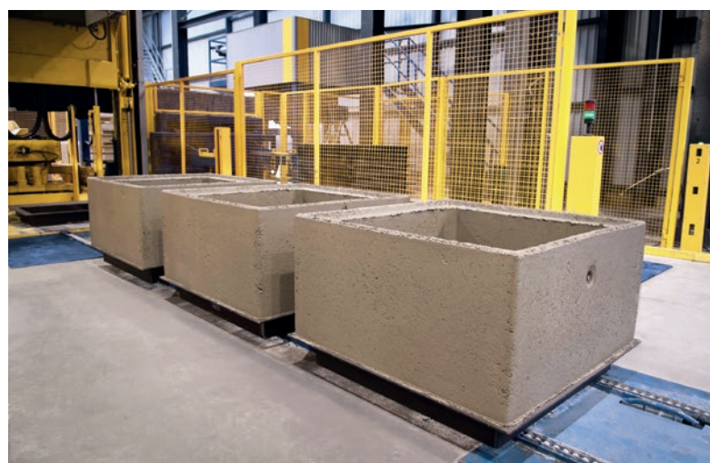
W CRP na maszynach Magic1501 produkuje się wyroby okrągłe oraz kwadratowe w szerokim zakresie wysokości konstrukcyjnych.
