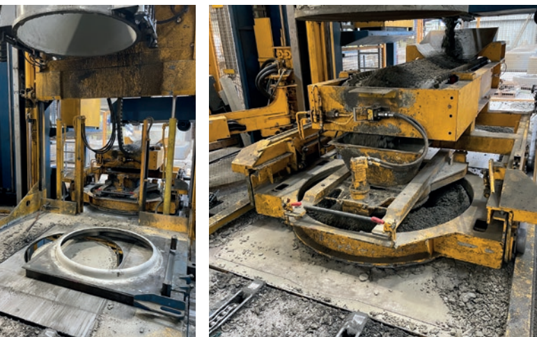
Produkcja kręgów betonowych na maszynie Magic 1.
