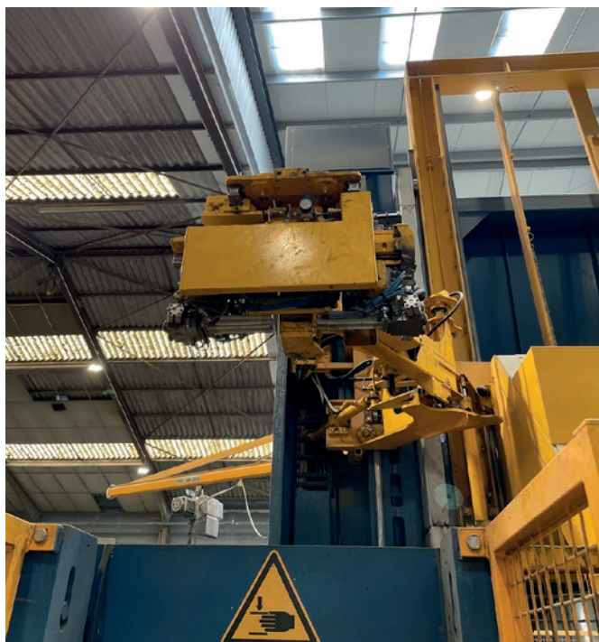
Automatyczny robot do podawania kotew transportowych.
