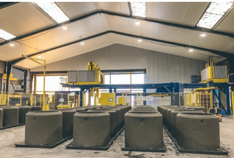
Stacja paletyzacji wykonuje duży zakres kroków produkcyjnych automatycznie.
