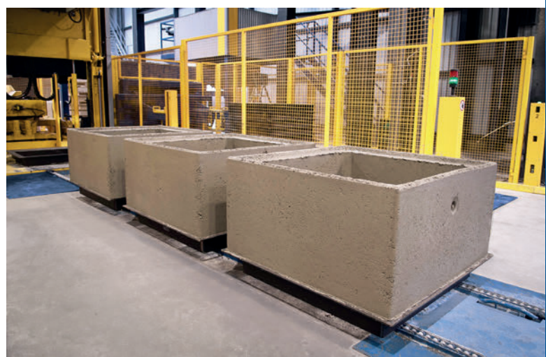
Presso CRP SAS, con Magic1501 vengono realizzati componenti per pozzetti sia quadrati che rotondi con diverse altezze.
