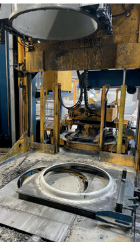
Produzione di anelli per pozzetti con l'impianto Magic 1
