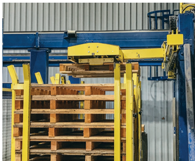
L'alimentazione continua di nuovi pallet in legno per il trasporto.
