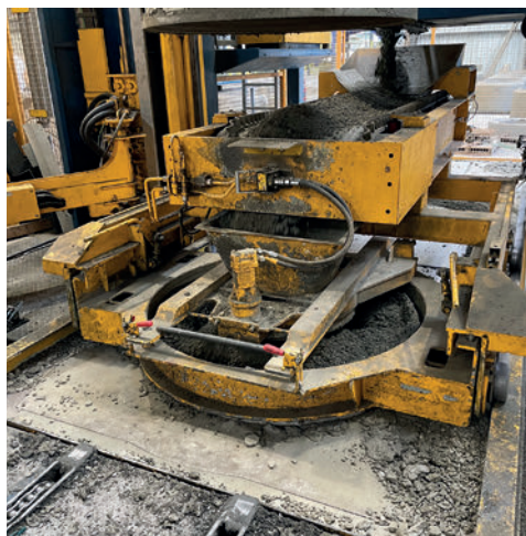
Produzione di anelli per pozzetti con l'impianto Magic 1
