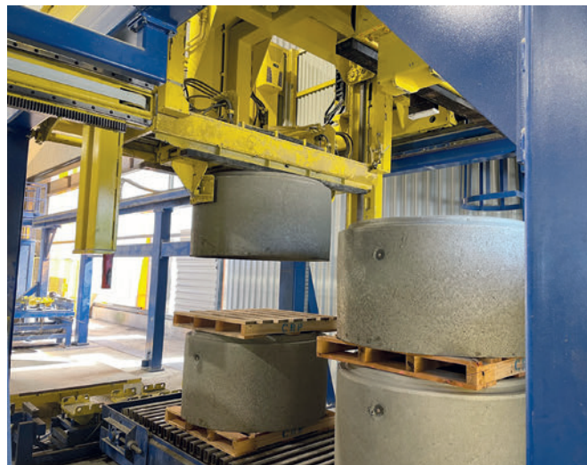
Pallettizzazione di anelli per pozzetti
