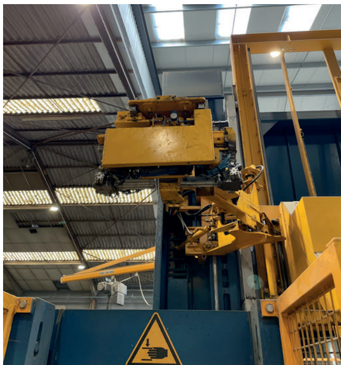
Robot di ancoraggio automatico dell'impianto Magic 1
