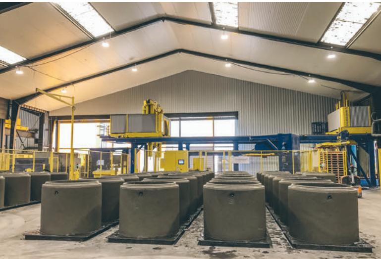
L'installation de palettisation prend en charge de nombreuses étapes de travail de façon entièrement automatisée
