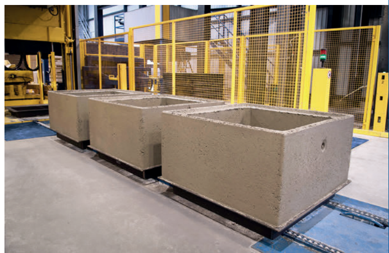
Chez CRP SAS, la Magic 1501 permet de fabriquer des éléments de regard carrés et ronds en plusieurs hauteurs
