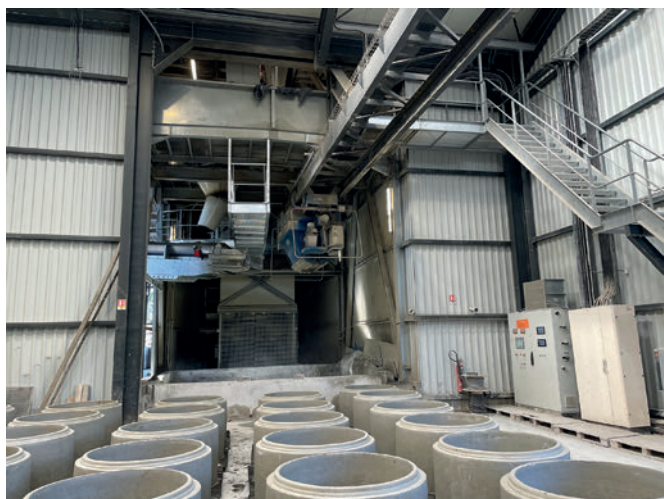
Le mélangeur Teka produit le béton pour l'ensemble des zones de production
