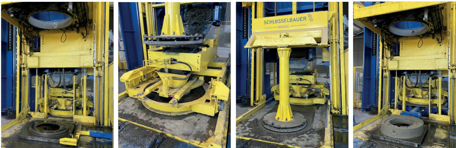
Vollautomatische Produktion von Schachtabdeckungen mit der Magic 2
