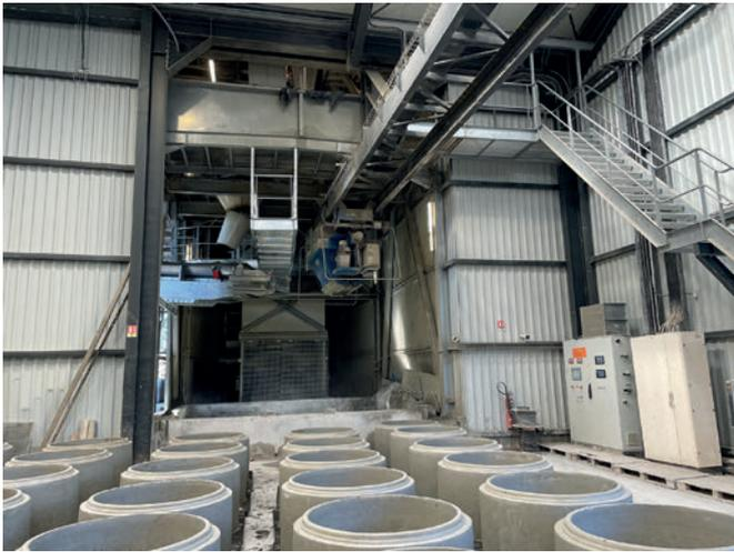
Die Teka-Mischanlage produziert den Beton für alle Produktionsbereiche.
