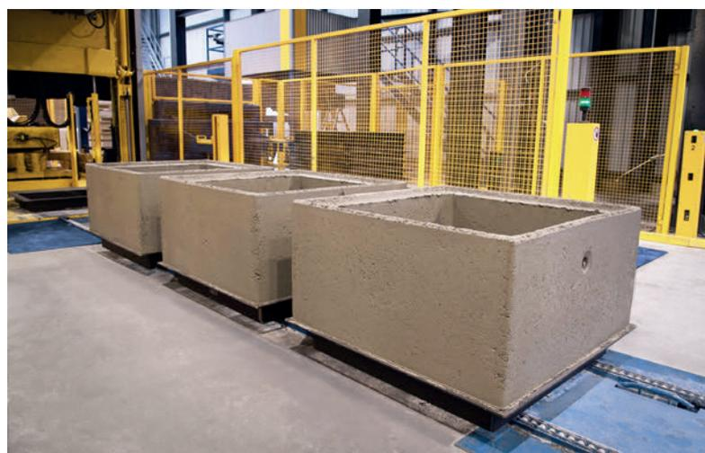
Bei CRP SAS werden mit der Magic 1501 sowohl rechteckige als auch kreisrunde Schachtbauteile in mehreren Bauhöhen gefertigt.
