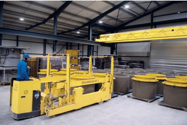
Mit einem der drei elektrischen Abfahrwagen werden die Produkte in den Aushärtebereich und später weiter zur Palettieranlage transportiert.
