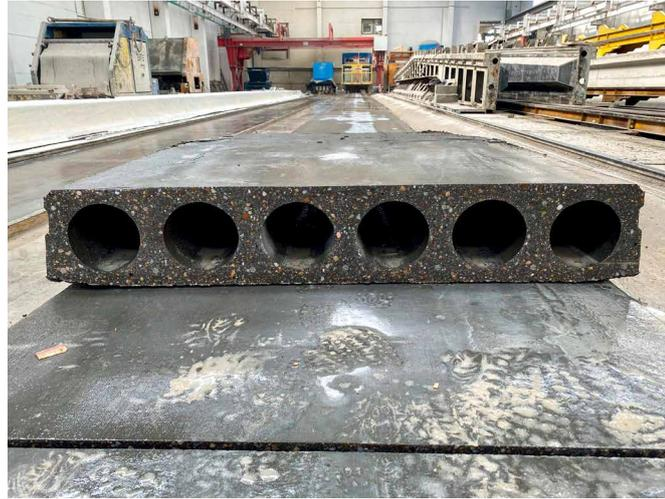
高度自动化的机械园区更容易实现中空芯板的高表面质量
