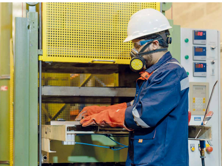
位于迪拜的 Topwerk 托普维克中东分公司为定制化的混凝土板材生产橡胶矩阵模具
