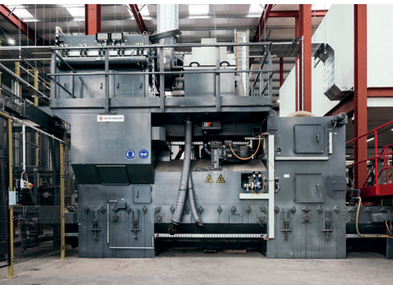
Дробеструйная установка SR-1250 оснащена двумя турбинами мощностью 18,5 кВт каждая с частотными регулированием
