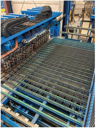
Благодаря максимальному количеству сварочных головок и дополнительному инновационному гибочному модулю GP Wapening может быстро изготовить армокаркасы специальной конструкции безупречного качества
