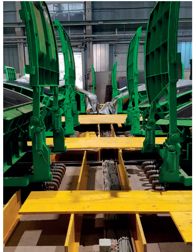
Производственные площадки австрийского завода оснащены двадцатью четырьмя формами для изготовления туннелей
