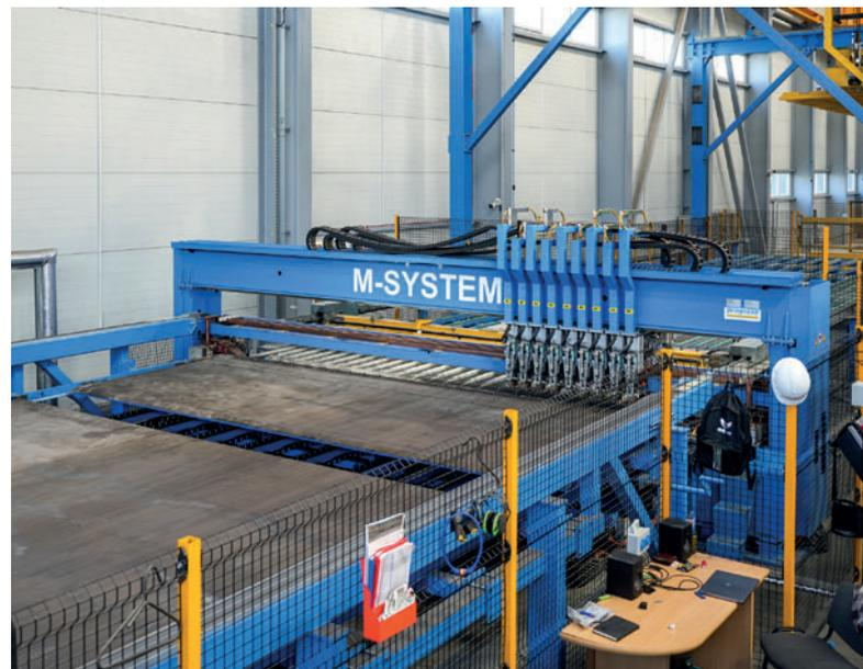
Автоматизированная система сварки сеток M-System обеспечивает высокую производительность, отличную эксплуатацию гибкость и выпуск продукции непосредственно с бухты
