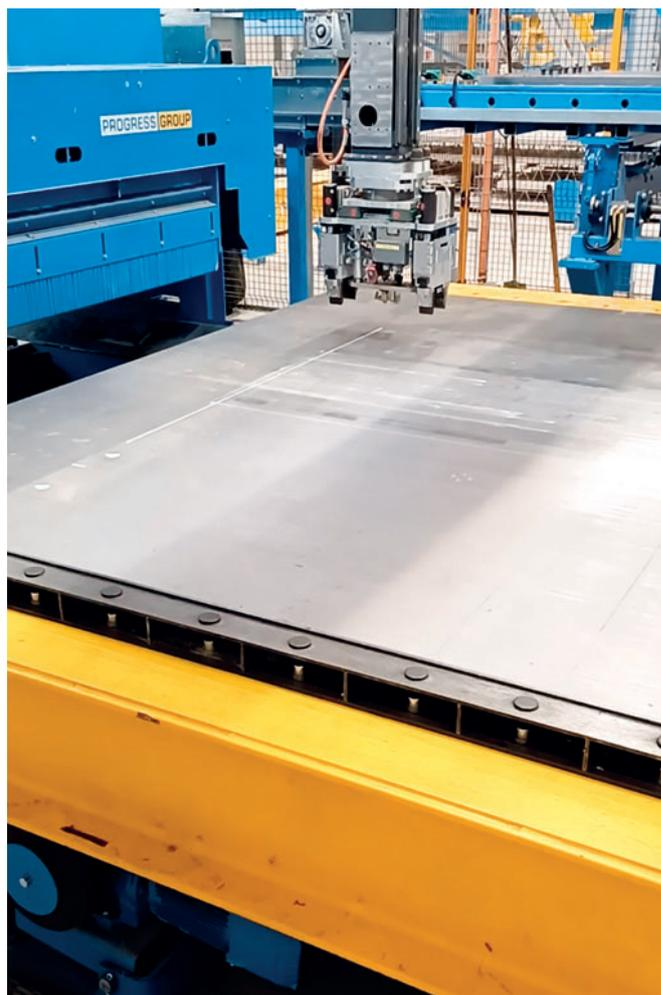
*Разметка для установки опалубочных элементов выполняется точно с помощью встроенного программного обеспечения и прецизионных лазеров*
