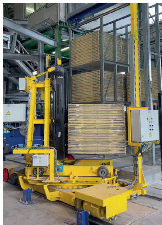
Новая транспортная тележка с поворотным устройством и телескопической мачтой надежно выполняет загрузку и выгрузку технологических поддонов
