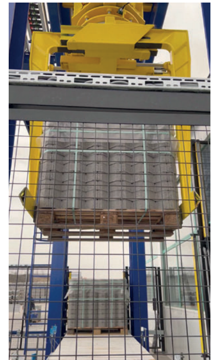
Передаточное устройство забирает готовые пакеты с блоками с помощью специального зажима и позиционирует их
