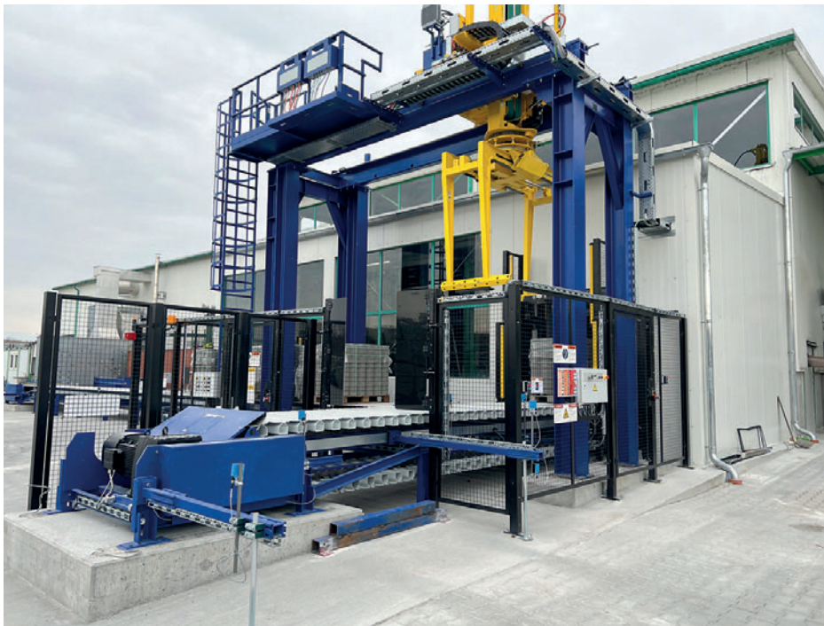
Передаточное устройство забирает готовые пакеты с блоками с помощью специального зажима и позиционирует их
