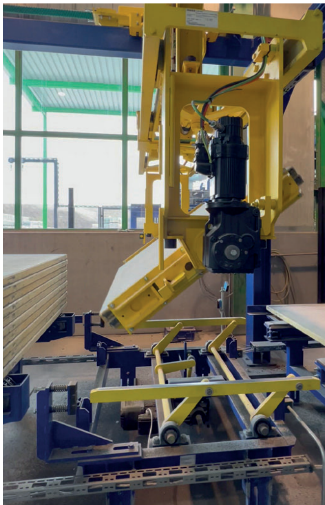
Передающее устройство с вертикальным поворотным механизмом для индивидуально регулируемой погрузки / разгрузки технологических поддонов
