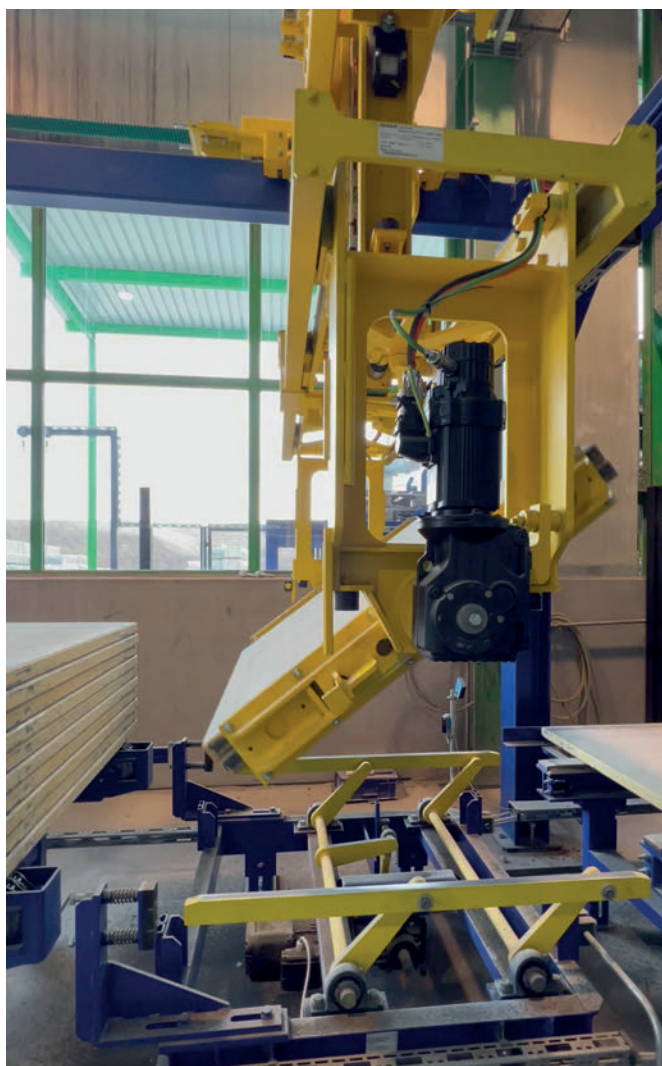
Il traslatore pacchi afferra i pacchi di blocchi finiti con una pinza speciale e li posiziona
