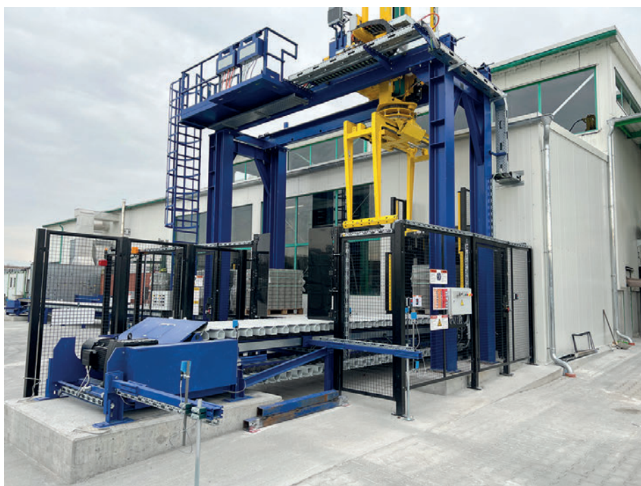
Il traslatore pacchi afferra i pacchi di blocchi finiti con una pinza speciale e li posiziona
