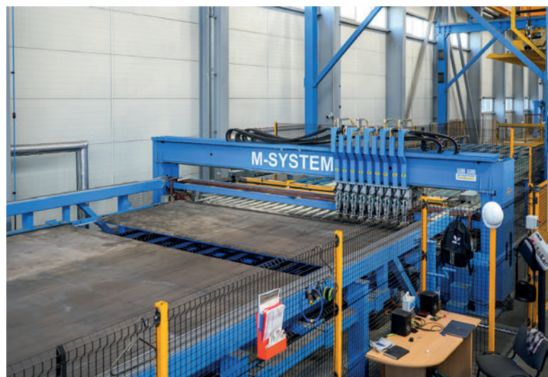
L'impianto di saldatura reti automatizzato M-System offre un elevato output, una grandissima flessibilità e produce direttamente dal coil.
