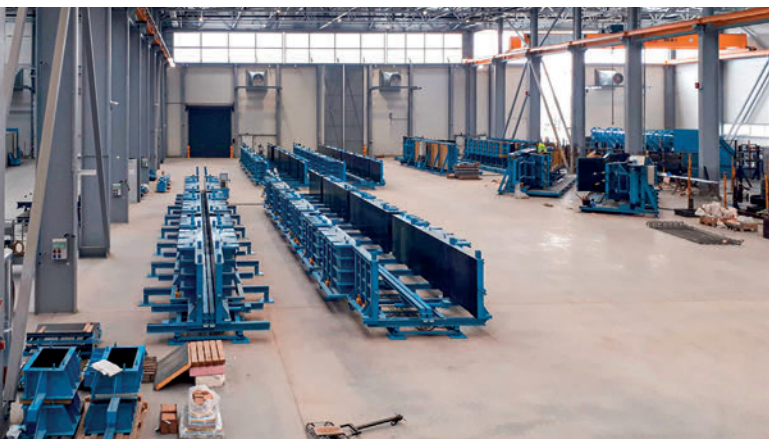
Capannone di Viastein Kft. con le casseforme per produrre pilastri, travi e scale.
