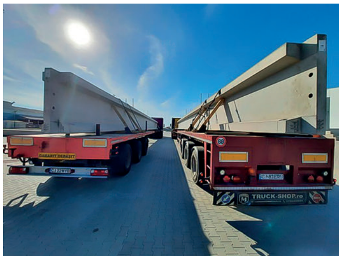
Le travi e i pilastri vengono prodotti in fabbrica e poi montati velocemente in cantiere.
