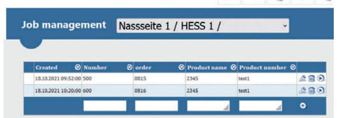
La gestion des commandes dans le module Professional permet à l'opérateur de l'installation d'enregistrer les produits planifiés, les temps et les quantités produites en fonction de la commande
