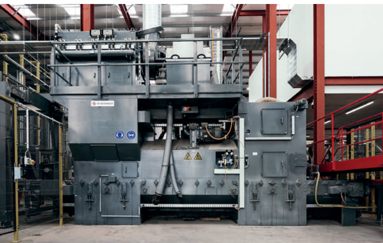
La grenailleuse SR-1250 est équipée de deux turbines à régulation de fréquence de 18,5 kW chacune.
