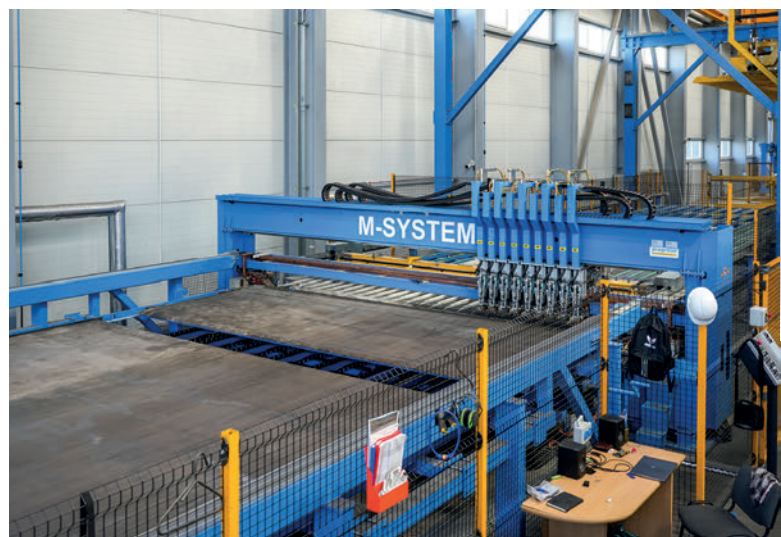
La ligne de soudage de treillis M-System offre un rendement élevé, une grande flexibilité et produit directement à partir de couronnes de fils.
