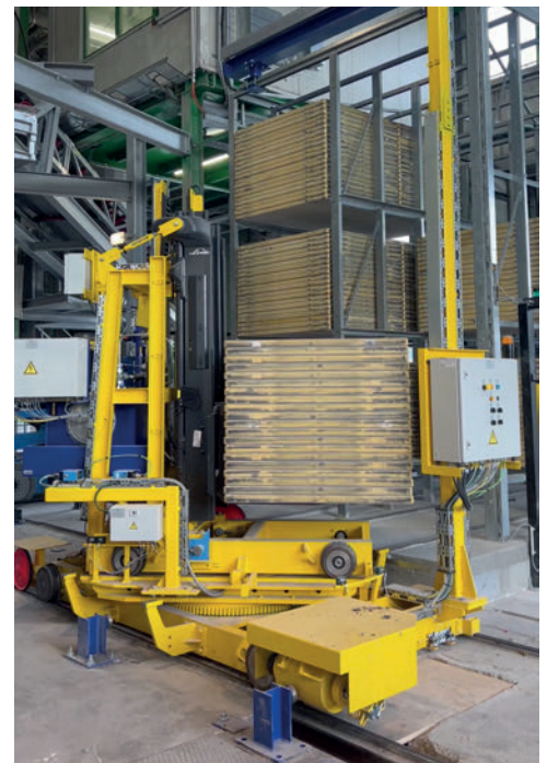
Le nouveau chariot de transport avec dispositif de rotation et mât télescopique prend en charge de manière fiable le stockage et le prélèvement des planches de support
