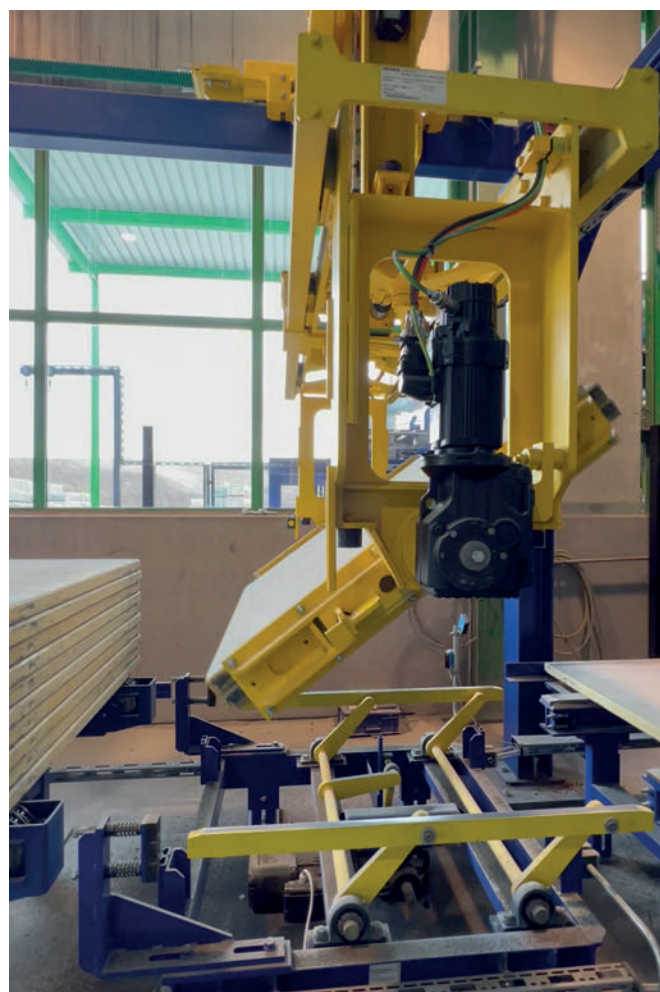
Translateur avec dispositif de rotation vertical pour la manipulation individuellement réglable des planches de support
