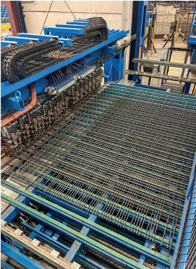
Con el número máximo de cabezales de soldadura y el innovador sistema de doblado adicional, GP Wapening puede fabricar rápidamente jaulas especiales sin ningún problema
