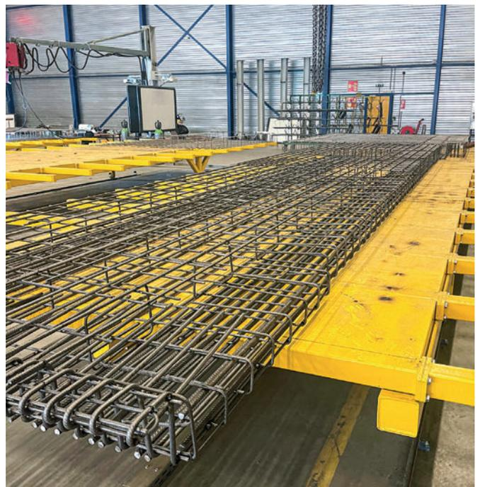
Con las soluciones de automatización innovadoras, los vanos y los doblados se ejecutan exactamente según el plano sin presentar problemas
