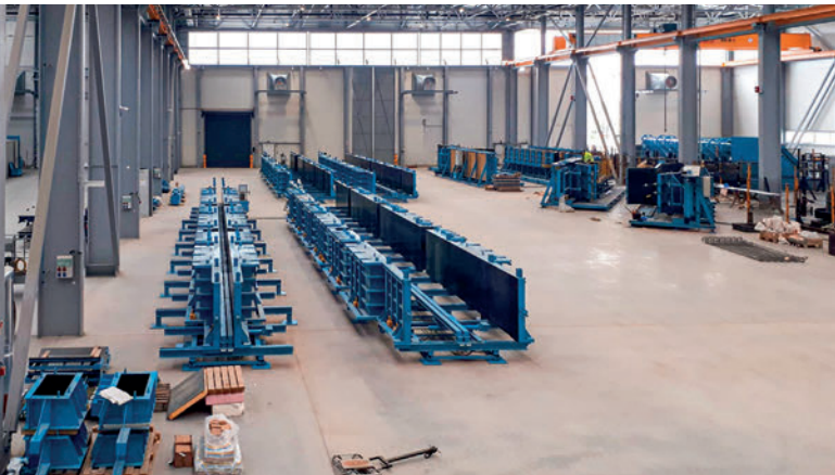
La nave de la fábrica de Viastein Kft. con los encofrados para fabricar pilares, vigas y escaleras
