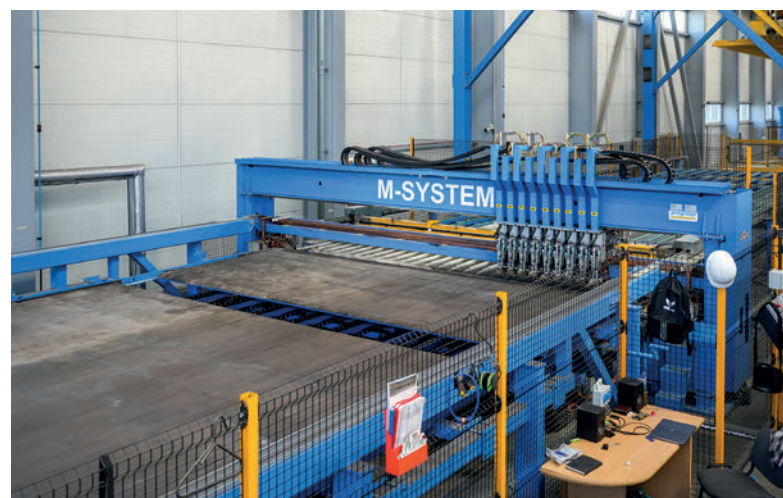
La instalación de soldadura de mallas automática M-System ofrece un volumen de producción elevado, una gran flexibilidad y lleva a cabo la producción directamente desde la bobina
