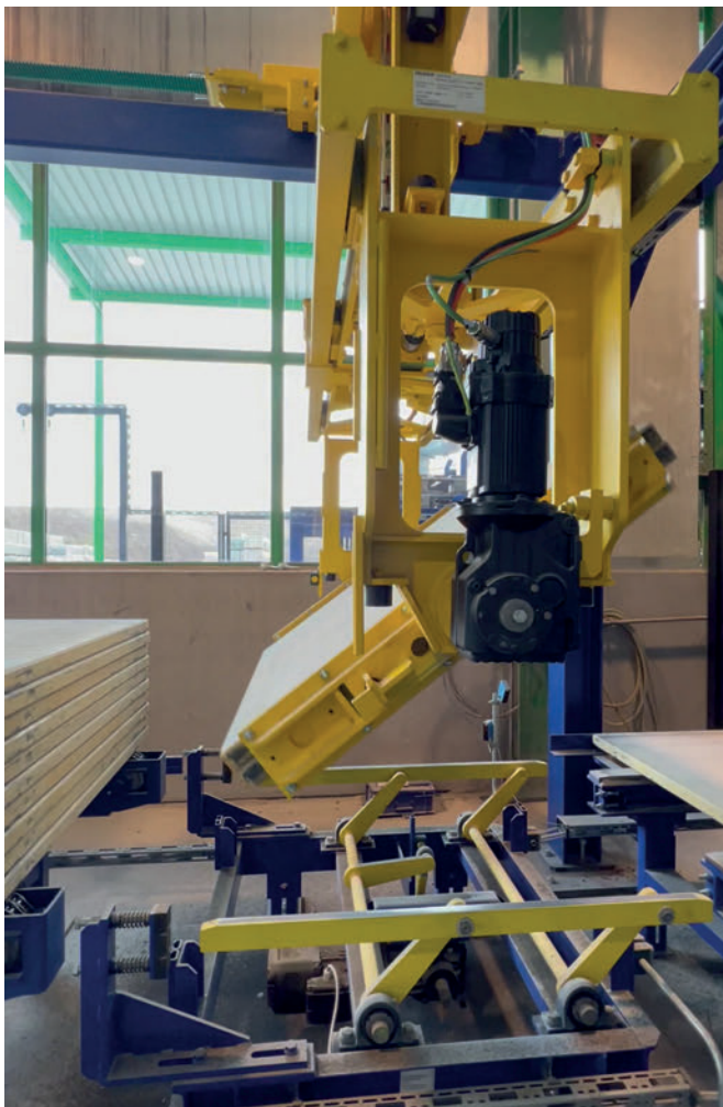
Paletizador con mecanismo giratorio vertical para una manipulación de las bandejas de regulación individual
