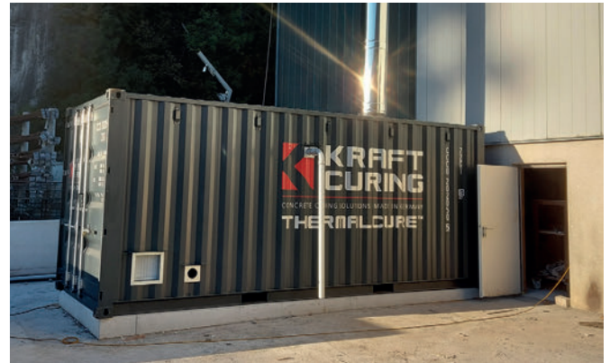
Für die Tübbingfertigung in Österreich ist auch ein ThermalCure-System von Kraft im Einsatz.
