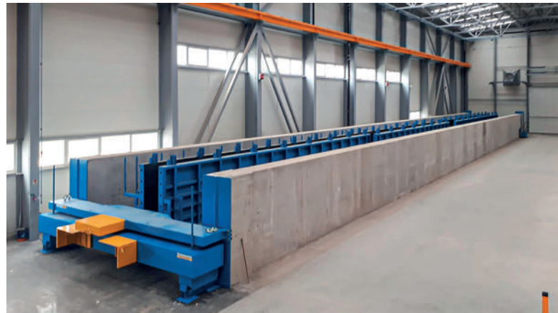
Werkshalle von Viastein Kft. mit den Schalungen für die Produktion von Stützen, Trägern und Treppen
