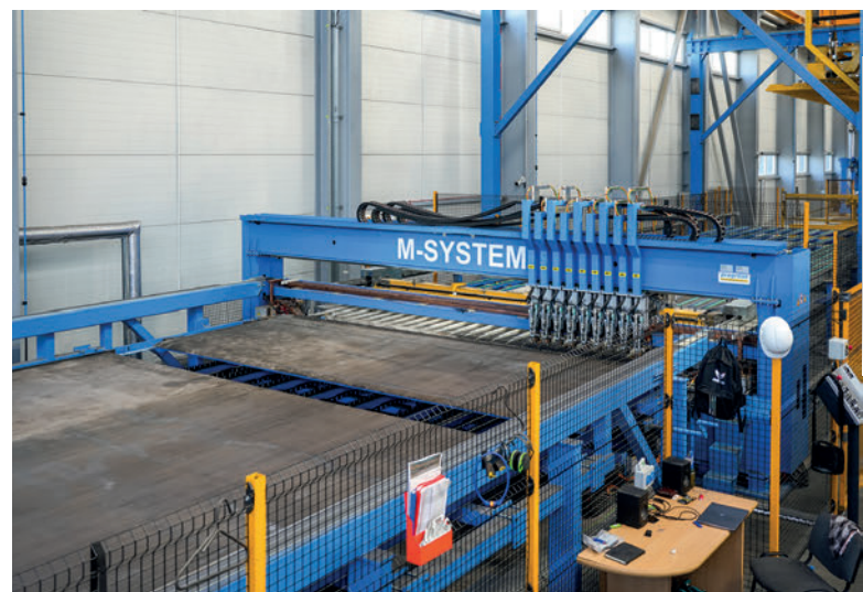
Die automatisierte Mattenschweißanlage M-System bietet einen hohen Output, sehr hohe Flexibilität und produziert direkt vom Coil.
