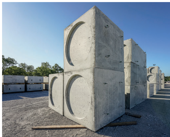
Neben individuellen monolithischen Perfect-Schachtunterteilen werden auf der Anlage auch Rechteck- und Standard-Schachtbauteile hergestellt.
