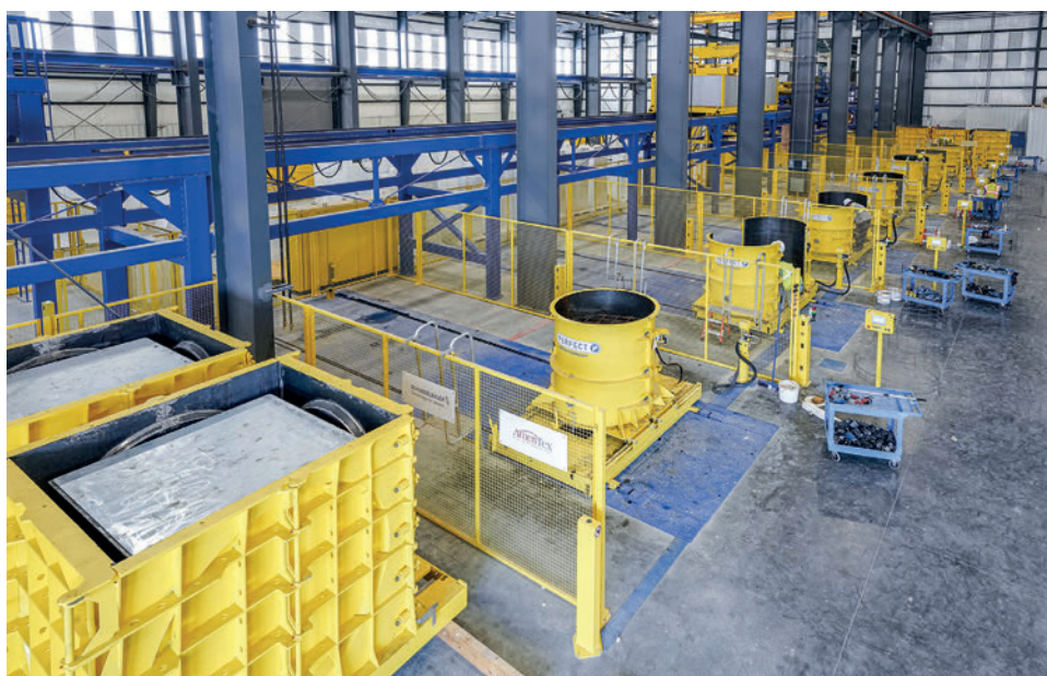
Mehrere Rüstplätze für Wet-cast-Formen sorgen dafür, dass es trotz unterschiedlicher Rüstzeiten zu keinen Verzögerungen im Gesamtsystem kommt.
