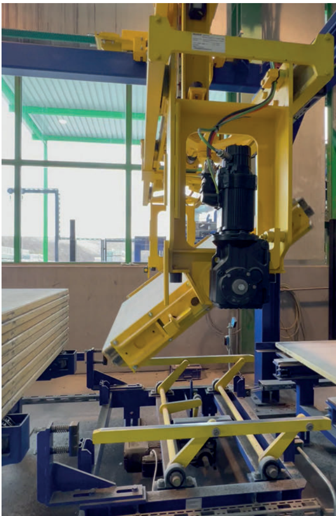
Umsetzer mit Vertikaldrehwerk für ein individuell einstellbares Handling der Produktionsunterlagen
