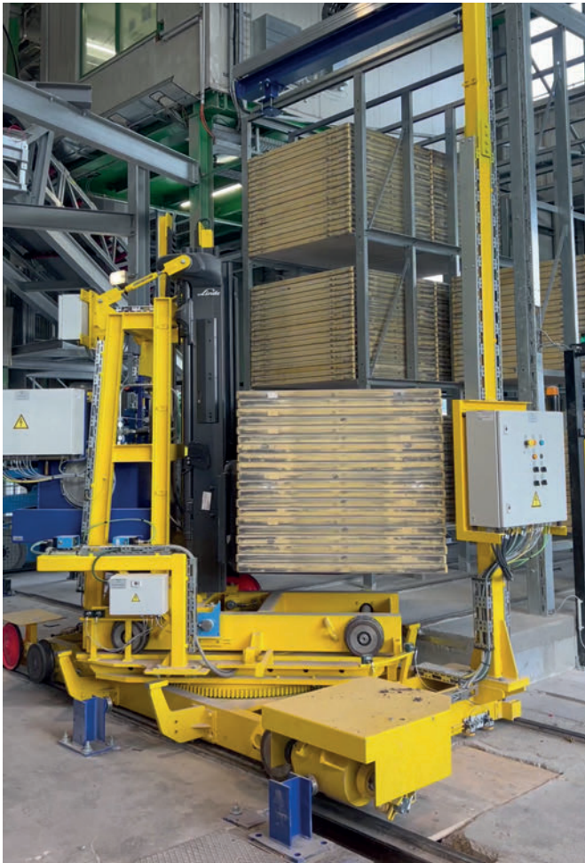
Der neue Transportwagen mit Drehvorrichtung und Teleskopmast übernimmt zuverlässig die Ein- und Auslagerung der Produktionsunterlagen.
