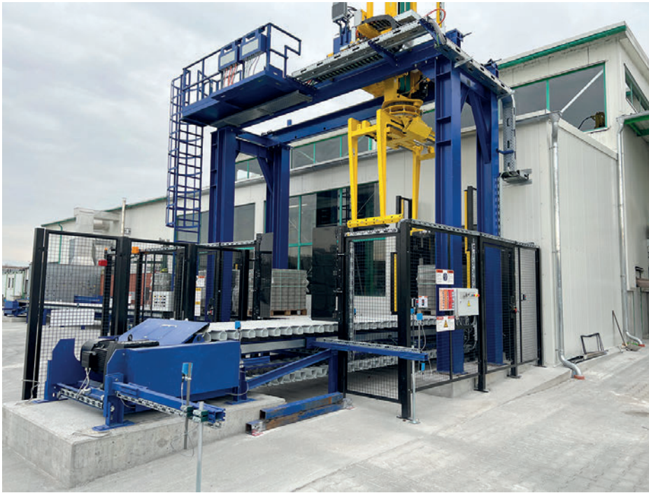
Der Paketumsetzer greift die fertigen Steinpakete mit einer Spezialklammer und positioniert sie.
