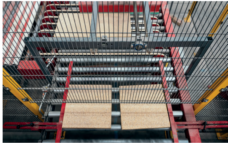
Die Strahlmaschine SR-1250 ist mit zwei je 18,5 kW starken frequenzgeregelten Turbinen ausgestattet.
