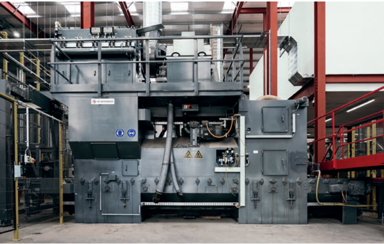
Die Strahlmaschine SR-1250 ist mit zwei je 18,5 kW starken frequenzgeregelten Turbinen ausgestattet.
