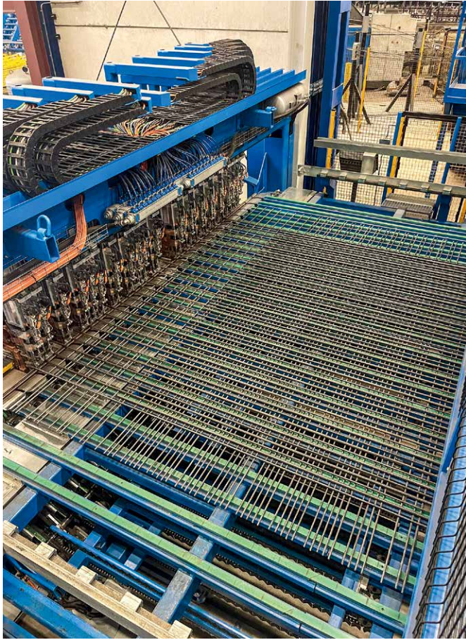
GP Wapening 公司可以使用最大数量的焊头和额外的创新弯曲技术快速生产无缺陷的特殊钢筋笼
