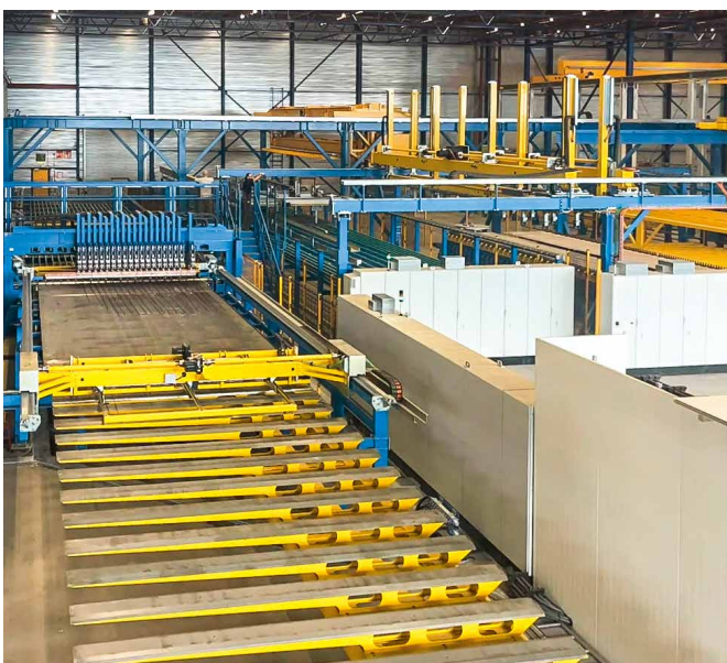
M-System Evolution 网状焊接设备的高产量令人尤为印象深刻
