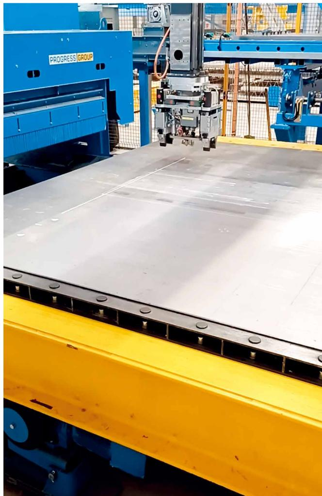
在集成软件和精密激光的帮助下，可以实现边模位置的精准标记
