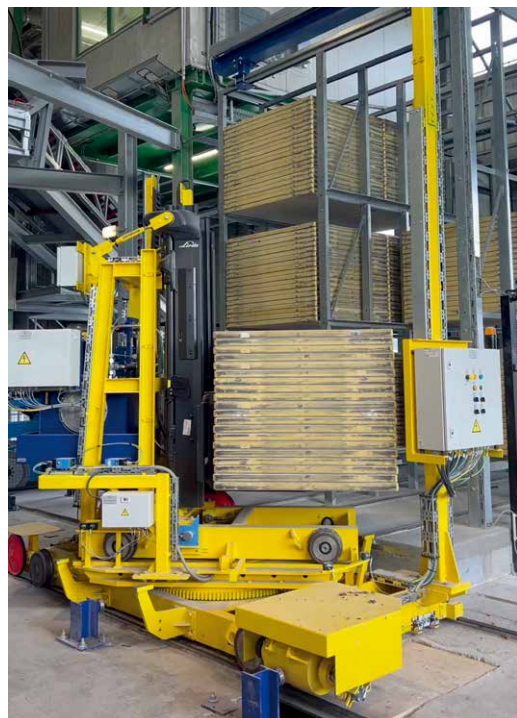
带有转向装置和伸缩桅杆的新型运输车以可靠的方式完成制品栈板的存放和取回
