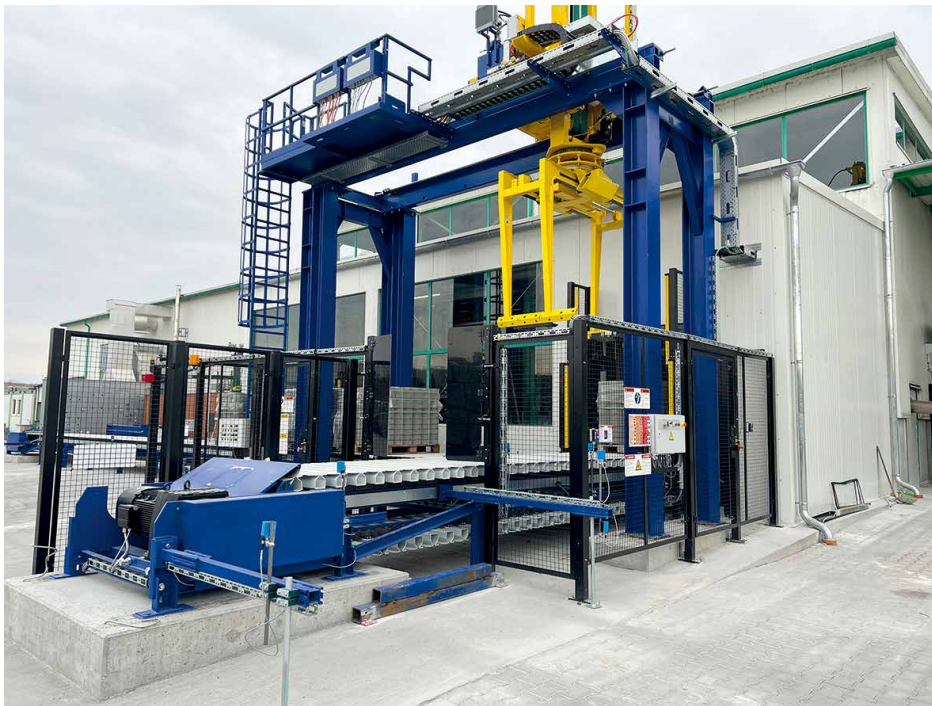
立方块移位装置通过特制的夹具抓取完工的立方块并对其进行定位
