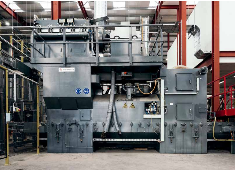
产品通过了 SR-1250 喷枪，该机配备了两台变频涡轮机，每台涡轮机的电气性能为 18.5 kW
