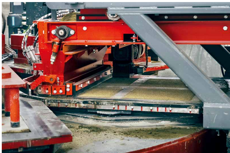
Tobermore 选择了 UNI 1200/6 密封压力机，该压力机具有六个工作站，用于生产双层混凝土板
