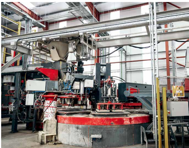
Tobermore 选择了 UNI 1200/6 密封压力机，该压力机具有六个工作站，用于生产双层混凝土板
