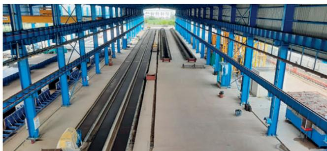
Многопустотные плиты на новом заводе Stellar Precast выпускаются на четырех линиях длиной 145 м
