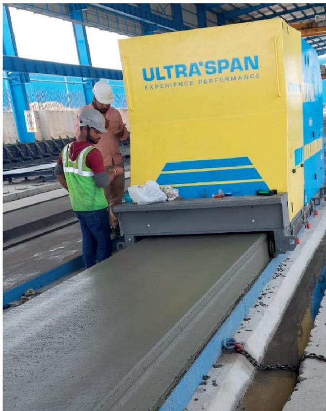
Экструдер компании UltraSpan обеспечивает быстрое и высококачественное производство многопустотных плит
