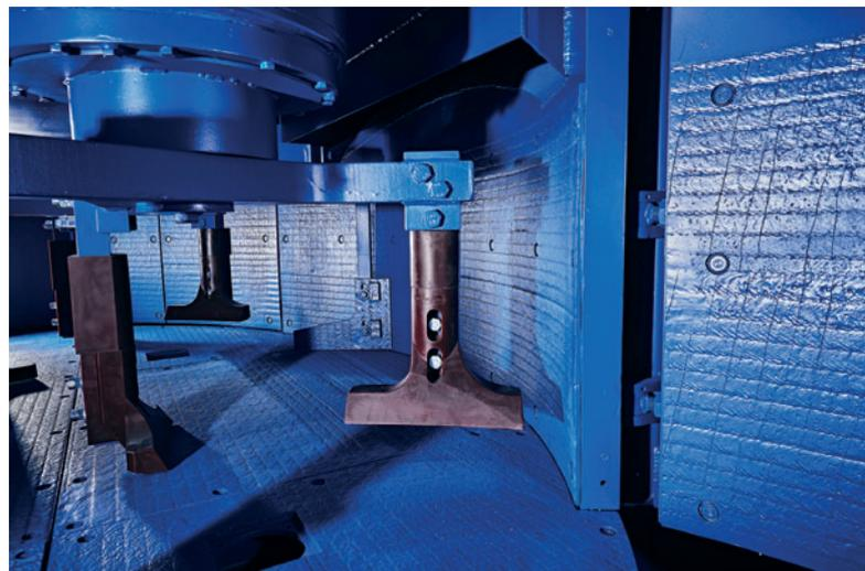
*Хорошо продуманное внутреннее устройство: прочные смесительные инструменты и боковые скребки, модульная конструкция и большие отверстия для доступа – это безошибочные характеристики серии РН, которые узнаваемы с первого взгляда*
