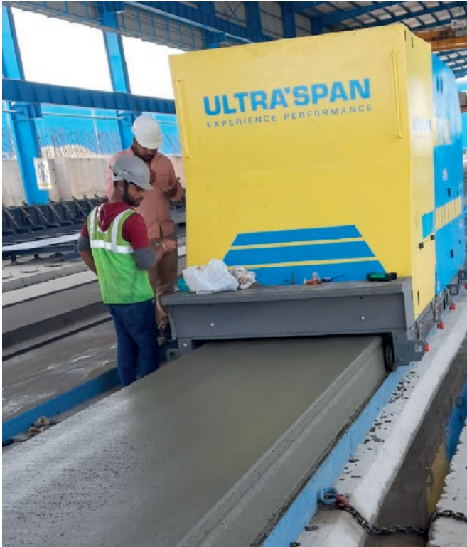
Ekstruder firmy UltraSpan zapewnia szybką produkcję wysokiej jakości płyt kanałowych.
