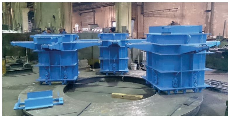
Płaszcze form wykorzystywanych w maszynie Variant do produkcji prostokątnych przepustów betonowych.
