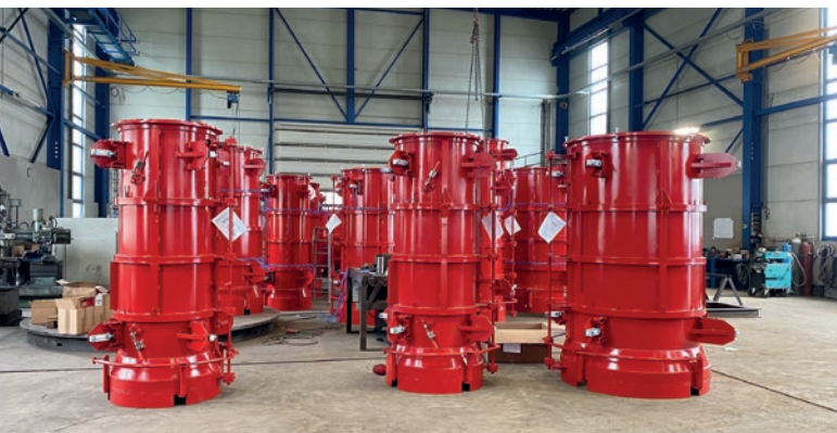
Różne płaszcze form wykorzystywanych w prasach radialnych do produkcji rur betonowych.
