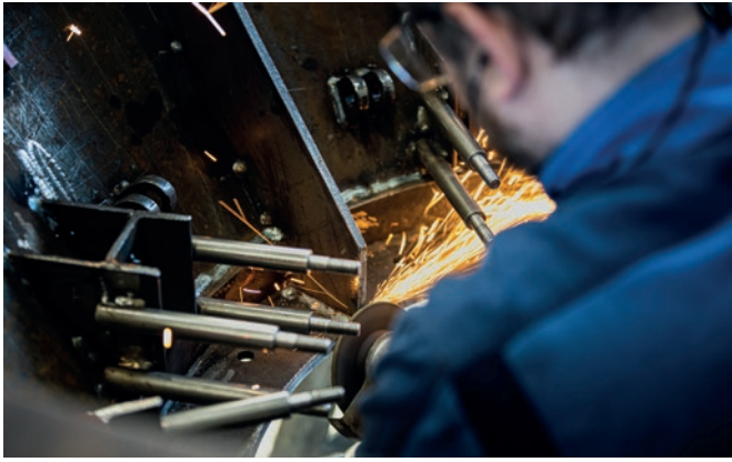
Obróbka stożkowego rdzenia formy wykorzystywanej w maszynie Tornado.
