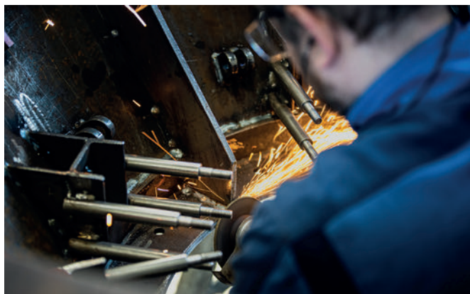
Lavorazione del nucleo per coni Tornado
