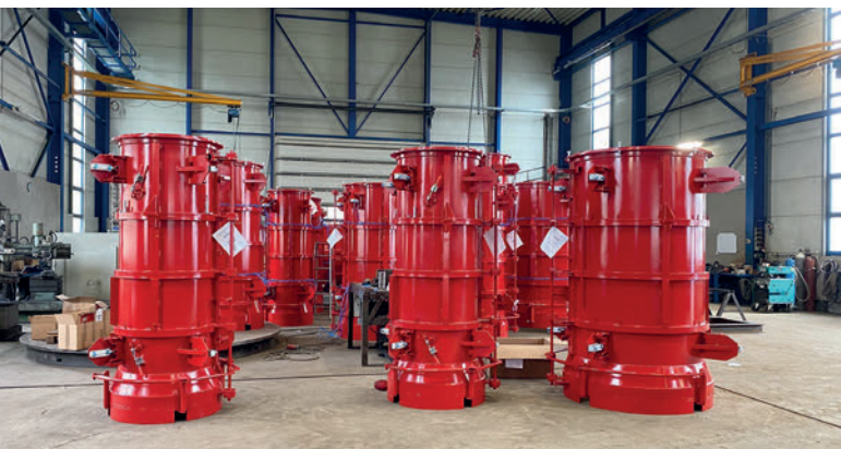
Vari rivestimenti degli stampi a pressa radiale per la produzione di tubi in calcestruzzo
