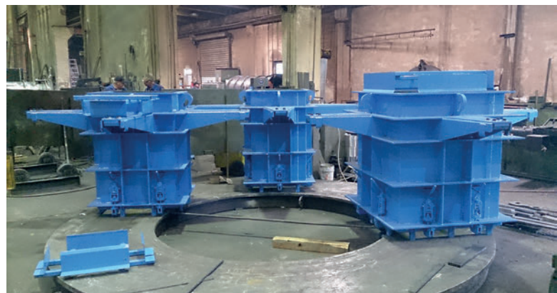
Rivestimenti di stampi Variant per la produzione di passaggi rettangolari in calcestruzzo
