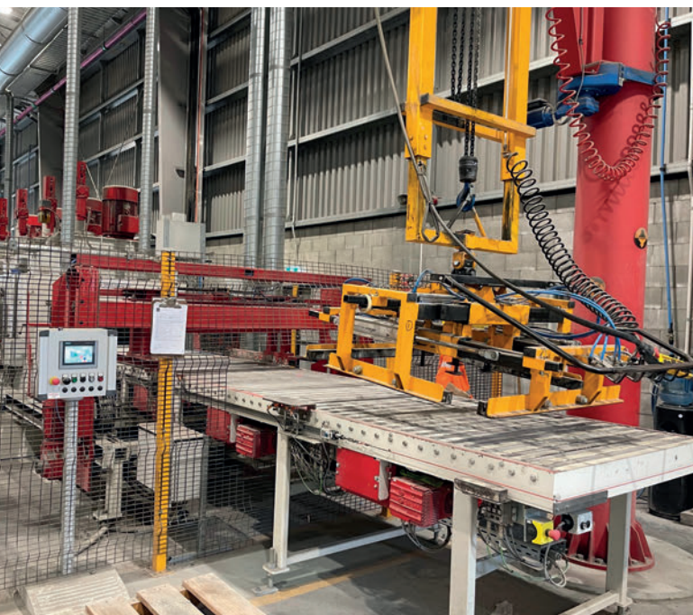
Caricamento con gru orientabile e pinza a 4 lati, trasportatore a rulli inserito nel sistema di sicurezza
